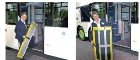
Die neue Rollstuhlrampe: Eveline Kienberger demonstriert die einfache Handhabung der in Bus untergebrachten, faltbare Rampe. Fazit: In maximal 40 Sekunden begehbar.
