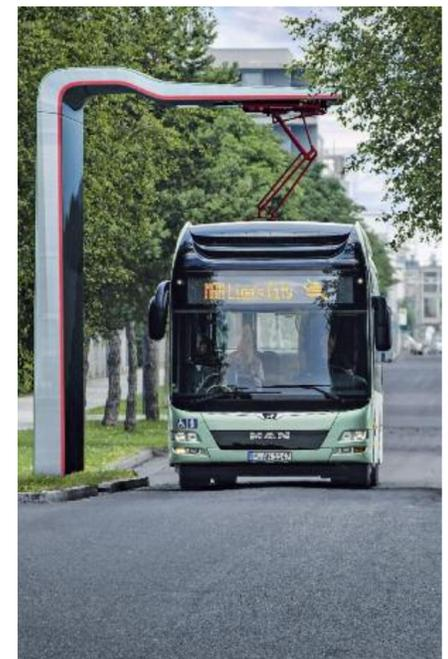
MAN hat verschiedene Ladetechniken parat – hier mit Pantograph.
